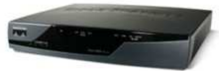
Ein Router verteilt ankommende Datenpakete an alle Netzwerkcomputer
